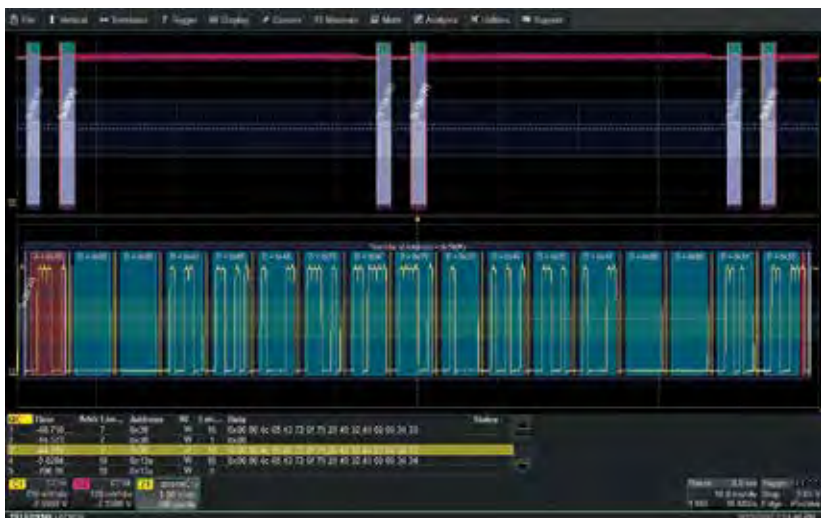
Информация о декодировании с наложением на физический уровень анализируемого протокола отображается в Таблице, расположенной ниже входного сигнала
